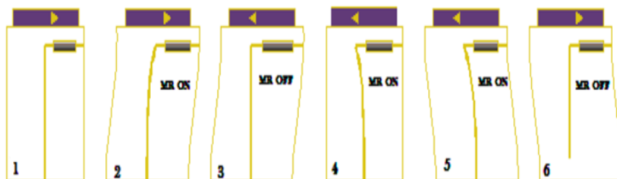
Figura 1-56 Funzionamento dell'algoritmo di Kamagata e Kobori
