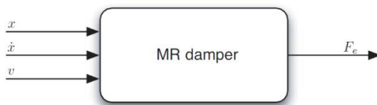
Figura 2-18: variabili dell'input / l'output dello smorzatore MR
