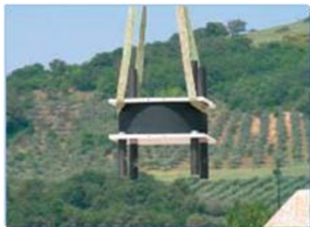
Figura 1-22: Isolatore elastomerico HDRB e il modello dinamico
