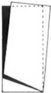
Figura 3-5: Meccanismo di rottura (ribaltamento) per pareti snelli
