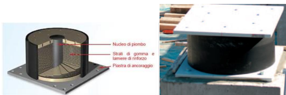
Figura 1-23: Isolatore elastomerico LRB
