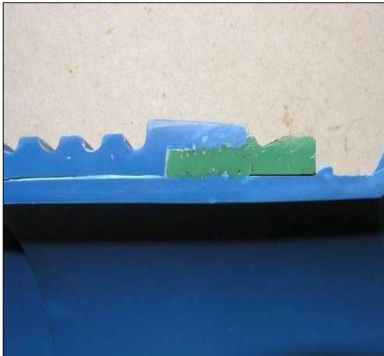
**Figura 4.21. Sezione di guarnizione elettrica dopo fusione dell'anello:
