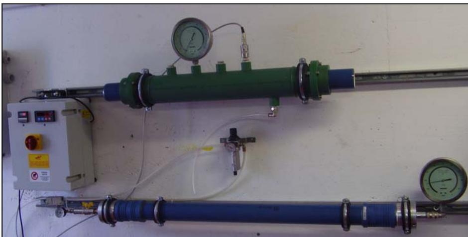
**Figura 3.6. I campioni di tubo soggetti a prova di compressione esterna e depressione**
