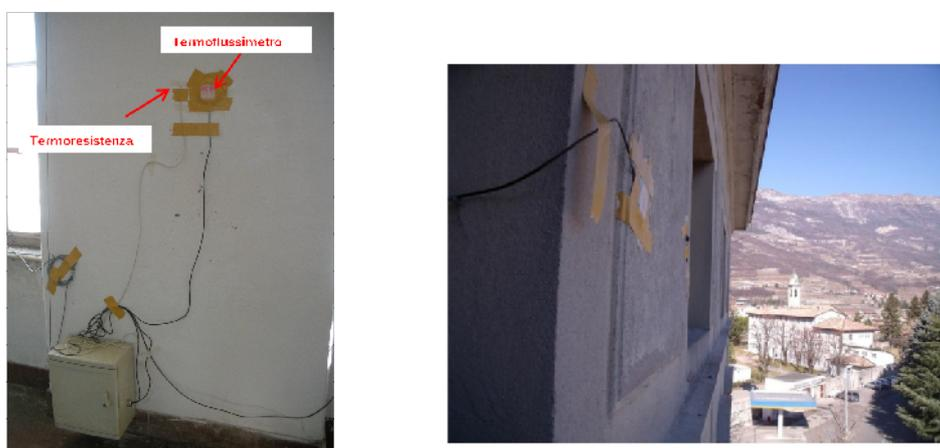
**Figura 2.3** Posizionamento sensori **a)** lato interno **b)** lato esterno
